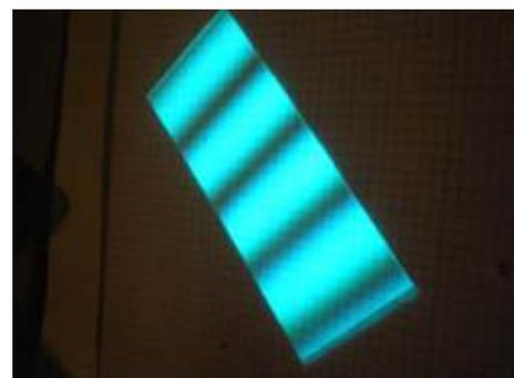
Abbildung 12: Quarzkeil mit 497nm-Filter
