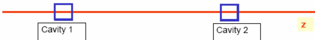
Teilchen laufen von links ins Cavity 1 ein. Um beschleunigt zu werden, muss die Phase des elektrischen Feldes richtig sein. Wir nehmen an, dass das Teilchen 1 zum Zeitpunkt  $t_0=0 \text{ ns}$  durch das Cavity 1 mit einer Spannung von 1 MV beschleunigt wird. Ein Teilchen welches zu einem anderen Zeitpunkt durch das Cavity läuft. Wird entweder weniger beschleunigt, oder sogar abgebremst.
