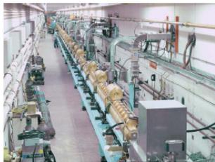
Linearbeschleuniger, wo sie auf 400 MeV gebracht werden. Am Ende des Linac (nach 150 m) werden die Ionen durch eine Kohlenstofffolie geschossen. So dass die Elektronen entfernt werden, man also einen Protonenstrahl erhält.
